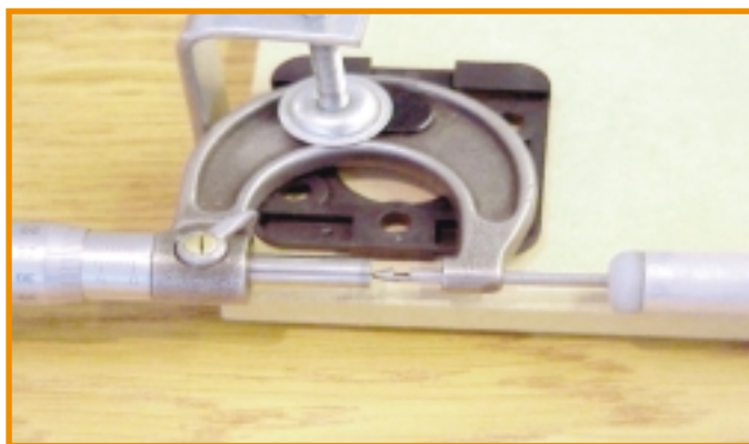
(Fig.18). Micrómetro utilizado para calibrar el sensor de desplazamiento.
